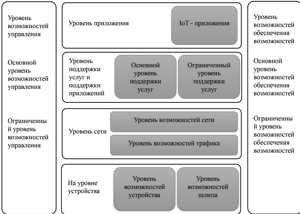
Рис.2. Архитектура IoT по стандарту (ITU-T) Y.2060 [2].
