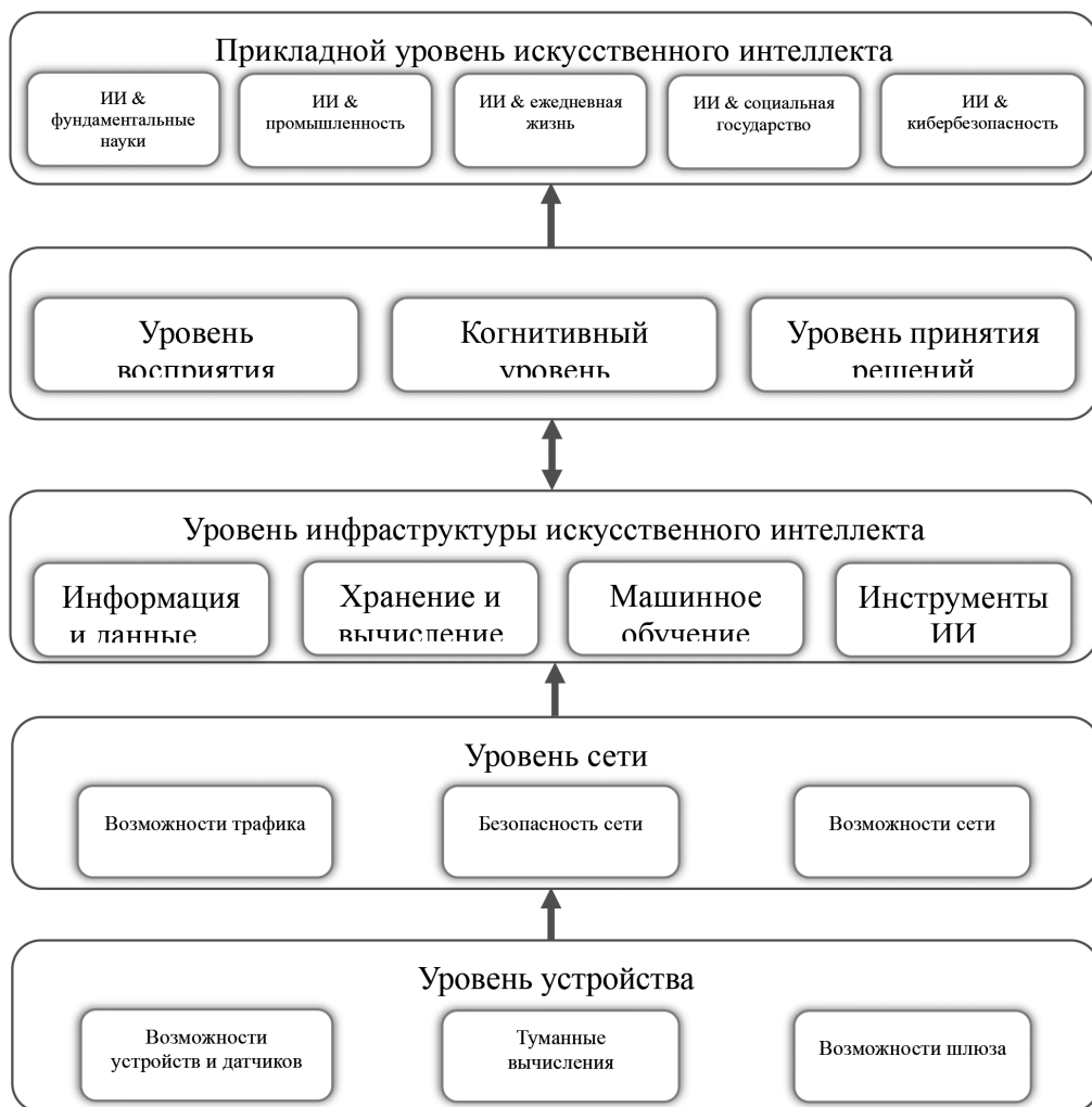
Рисунок 4. Предлагаемая структура искусственного интеллекта, интегрированная с технологией интернета вещей
