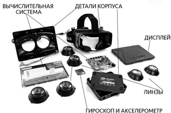
Рис.1 Устройство шлема виртуальной реальности
