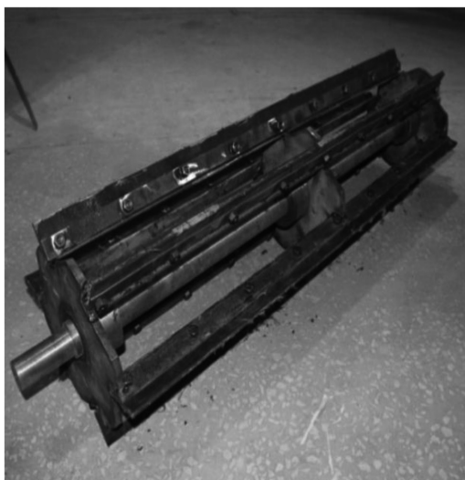
3- rasm. Separator-tozalagichning to'rtli yuzasi orqali paxtani tashish uchun havo o'tkazuvchan plankali barabanning sxemasi va umumiy ko'rinishi
