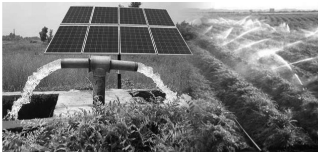
1-Rasm quyosh energiyasi bilan ishlaydigan doimiy suv nasosi
